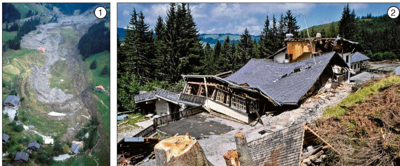
Fig. 3: Réactivation catastrophique du glissement de Falli-Höllli en 1994. Image 1: La partie médiane du glissement emporte le village de vacances composé d'une quarantaine de bâtiments. Image 2: Les mouvements de terrain entraînent l'effondrement du restaurant de Falli-Höllli le 21 juillet 1994.
